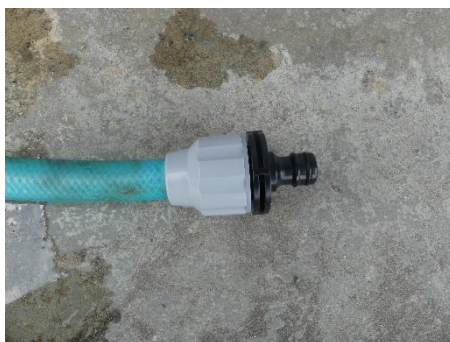
(4) ホースにジョイントニップルを取り付ける
