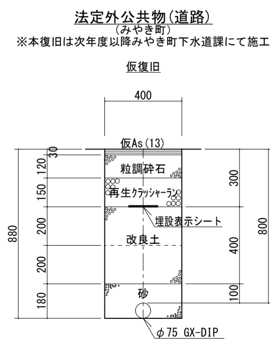
配水管布設工 2
